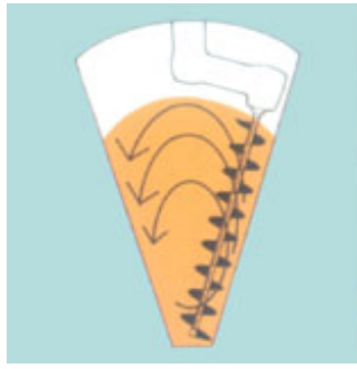
A：混合螺杆通过自转用来提升物料
