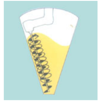
C：物料从螺杆甩下，被带到槽后对面，如此循环，完成混合
